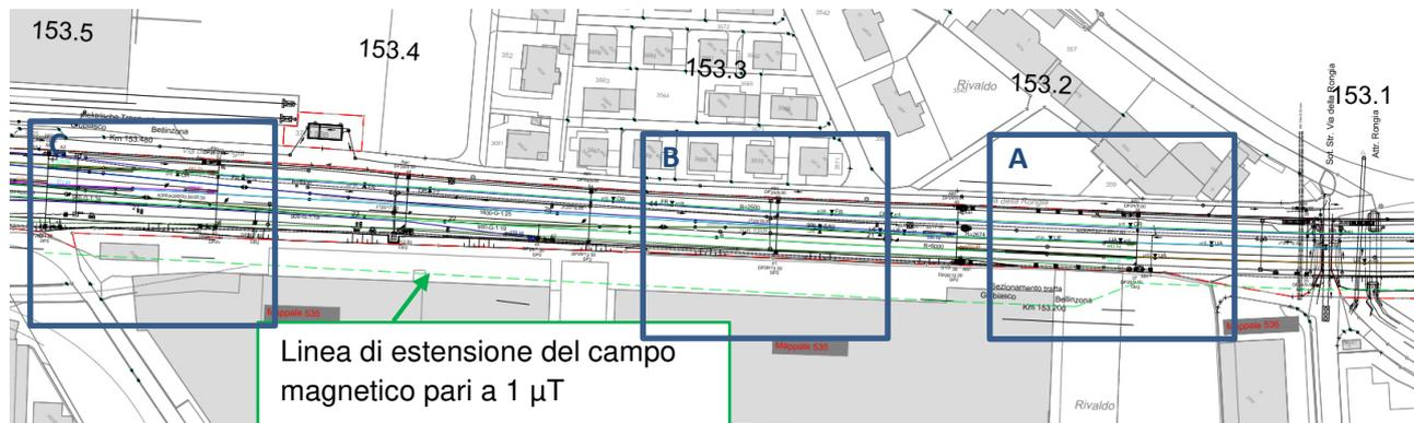
Figura 1: situazione e linea di estensione del campo magnetico pari a  $1 \mu\text{T}$ .
