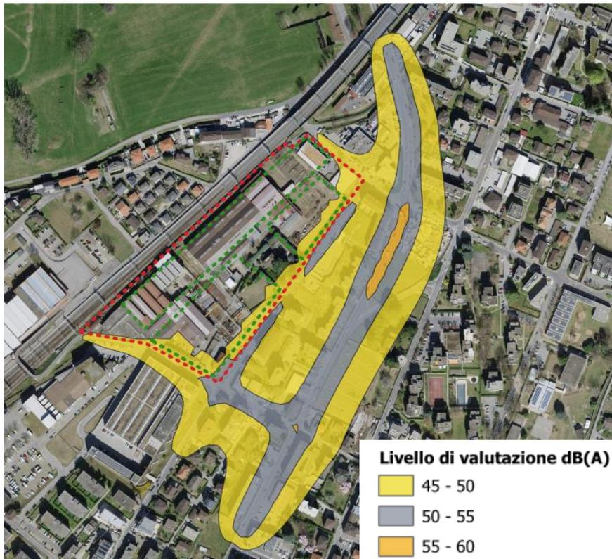
Figura 20: Isofona [dB(A)] rumore stradale di notte calcolato a un'altezza di 4.5m dal p.c. Il perimetro rosso costituisce il limite di progetto e quello verde la linea di arretramento degli edifici.
