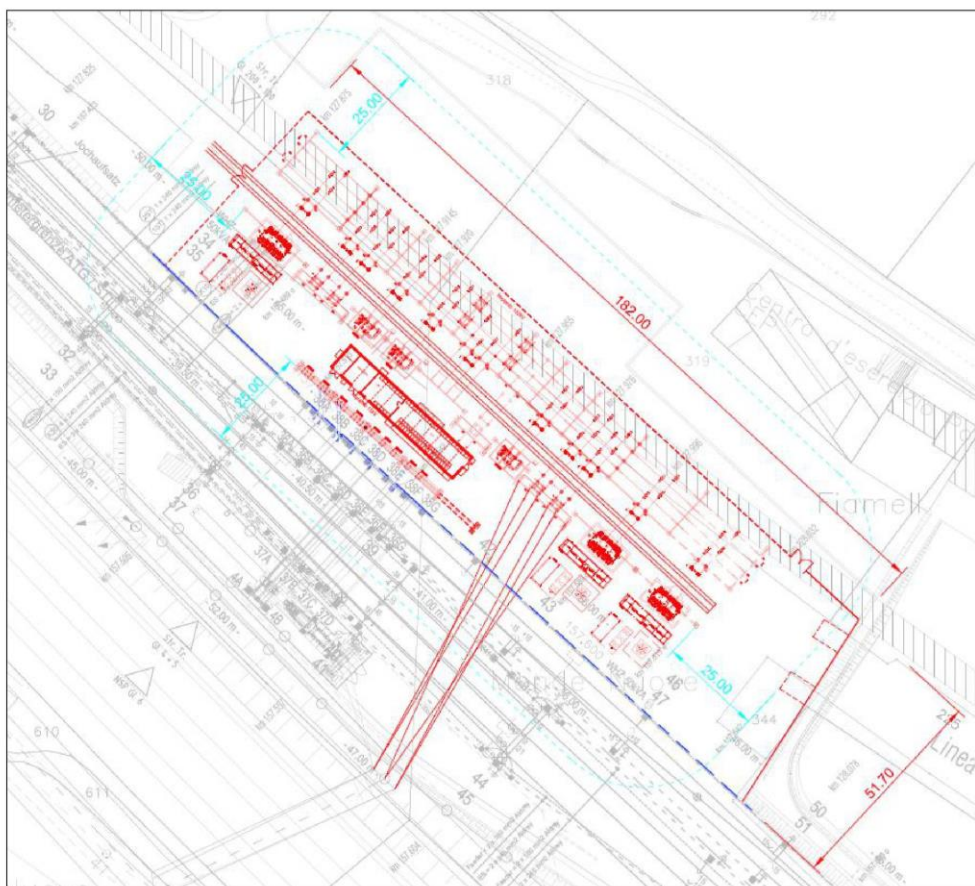
Figura 4: definizione del valore limite di 1 \mu T definito dall'art. 14 dell'ORNI (linea azzurra tratteggiata)
