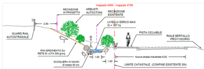
Figura 5: sezione tipo riale Bertallo valorizzato
