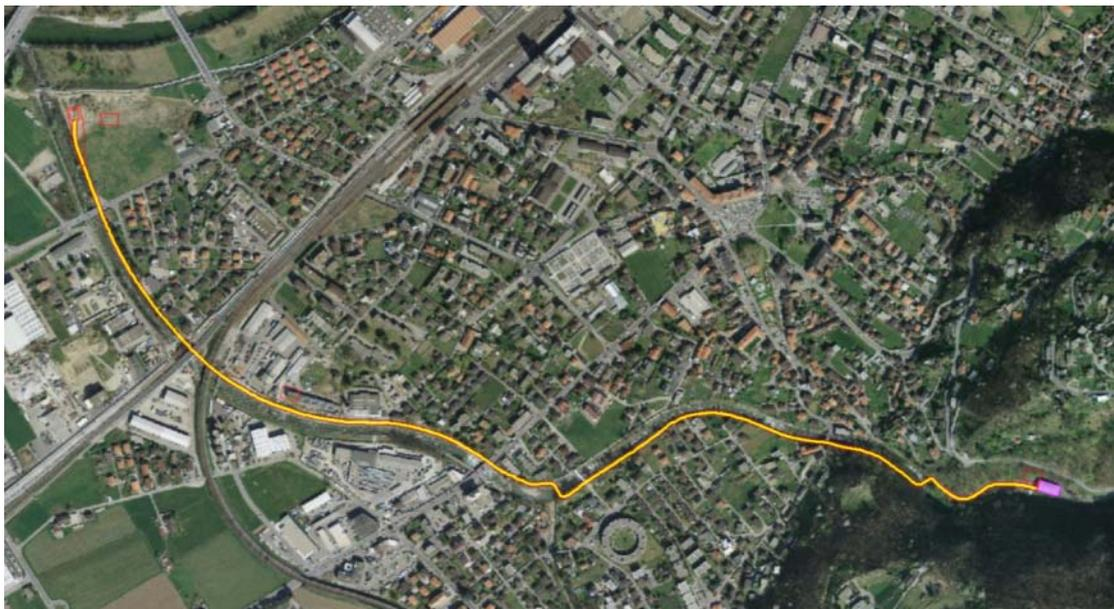
Figura 6-1: tracciato della nuova condotta sotterranea (in giallo) tra la centrale di Giubiasco (in viola) e il fiume Ticino. In rosso sono indicate le aree interessate dal progetto.
