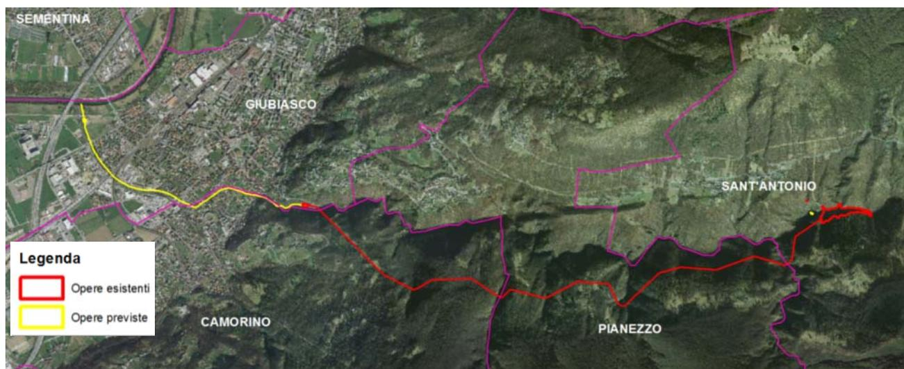
Figura 3-1: area interessata dal progetto (©Swisstopo, ortofoto 1313-41 e 42, 1314-31). In rosso sono indicate le strutture esistenti della centrale idroelettrica e del bacino di accumulazione, in giallo indicativamente le nuove opere proposte.
