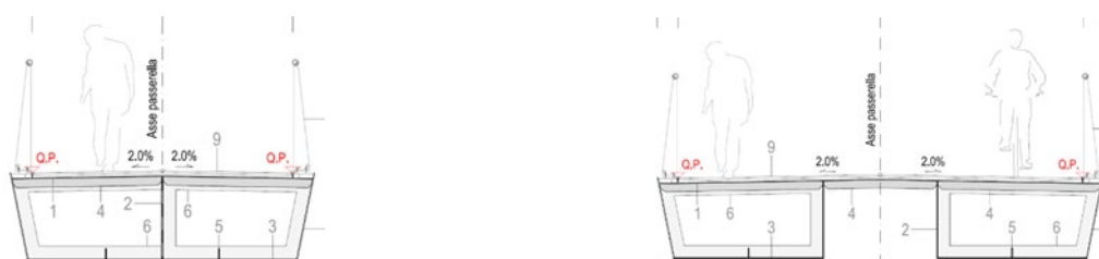
"Sezioni trasversali tipo": cassone bi-cella a larghezza variabile
