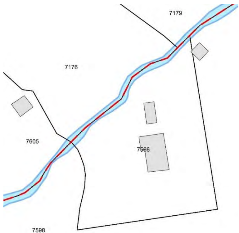
Fig. 11 A sinistra asse del riale (tratteggiato in rosso) ottenuto come mediana delle linee di sponda del poligono che rappresenta il corso d'acqua (in azzurro). A destra dettaglio della correzione effettuata all'asse del corso d'acqua ("smoothing"). In verde l'asse teorico determinato come mediana delle linee di sponda e in rosso l'asse definitivo corretto.
