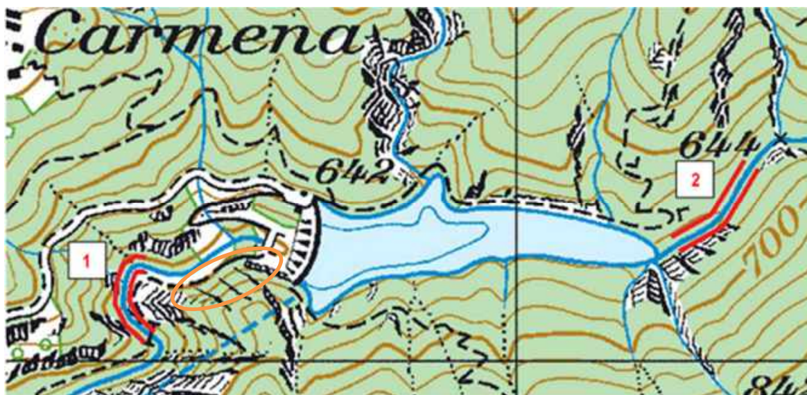
Figura 1 – Estratto della CN25 con evidenziati in rosso i tratti del riale Morobbia considerati per la determinazione della larghezza naturale dell'alveo (LnFA) e in giallo il tratto in esame, per il quale si vuole definire lo spazio riservato alle acque (SRCA).
